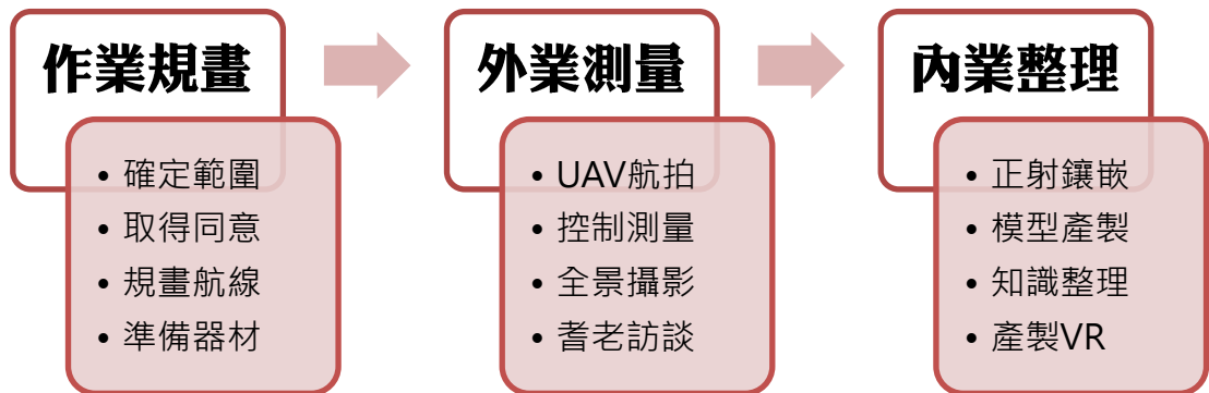
圖 7 虛擬原鄉測製流程
