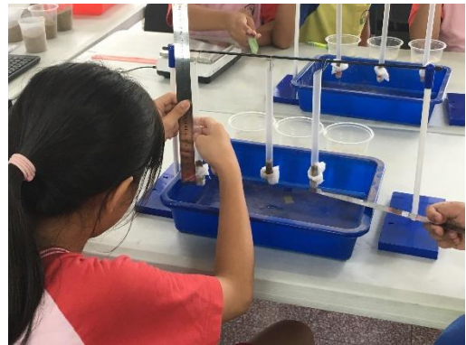
圖 36 學生以尺測量砂土吸水高度
