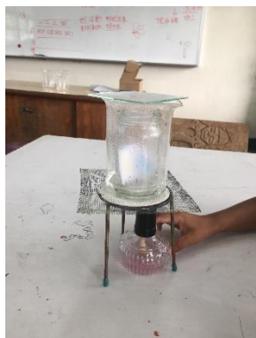
圖 7 以燒杯實驗製造濕氣
