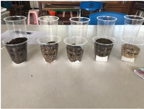
圖 27 五種土沙混合比例不同的濾杯
