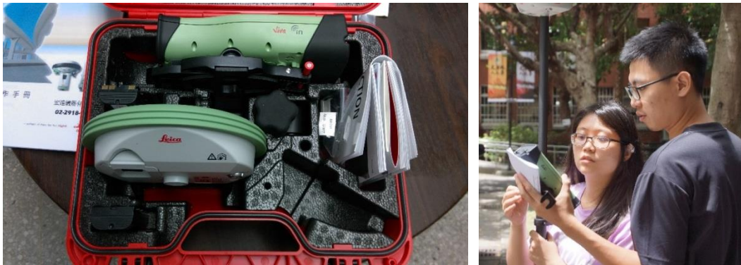
圖 9 德國徠卡 (Leica) 公司出品之 GS08 plus GNSS 天線及 CS10 接收儀控制器
